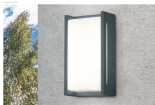
LED-Wandleuchte Aluminium Druckguss, Kunststoff weiß B 130, H 233 inkl. 2x4 W/2x500 lm/3000 K
