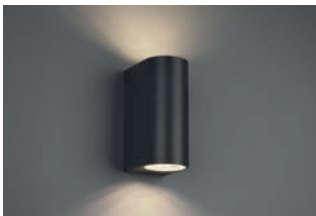
Fassadenleuchte Aluminium/Druckguss anthrazit exkl. max. 35 W, 2xGU10, H 150, B 69, T 92 up/down-Beleuchtung
