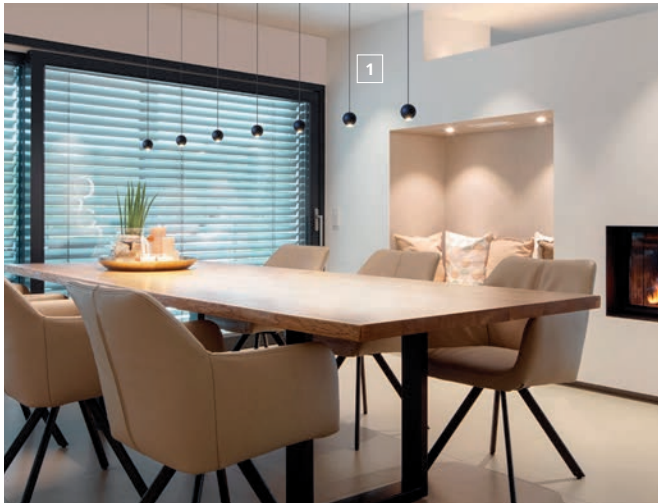
[1] LED-Pendelleuchte Aluminium, Glas transparent Kugel AD 50, 4,5 W/220 lm/3000 K Kabel 1,50 m, schwarz oder weiß
