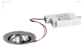
LED-Einbaustrahler-Set rund und eckig Hochleistungs-LED für den Einsatz im Bereich der Allgemein- oder Akzentbe- leuchtung. Montage in Hohldecken mit Federbefestigung. Inkl. Betriebsgerät für 230 V-Netzspannung. Nicht zur Abdeckung mit Wärmedämm-Material geeignet.
