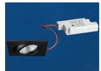
LED-Einbaustrahler-Set Aluminium/Stahl/Silikonkautschuk/ Kunststoff ED 68, H 50 inkl. 6 W/650 lm/3000 K/230 V Phasenabschnitt dimmbar Set inkl. Betriebsgerät L 110, B 50, H 19 schwenkbar
