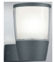
LED-Fassadenleuchte Aluminium Druckguss, anthrazit/ Kunststoff, weiß, AD 110, H 170, T 130 inkl. 7 W/660 lm/3000 K
